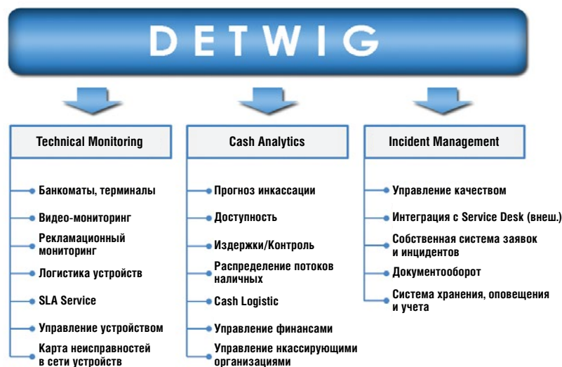
Рис. 2. Ключевые блоки системы мониторинга Detwig
